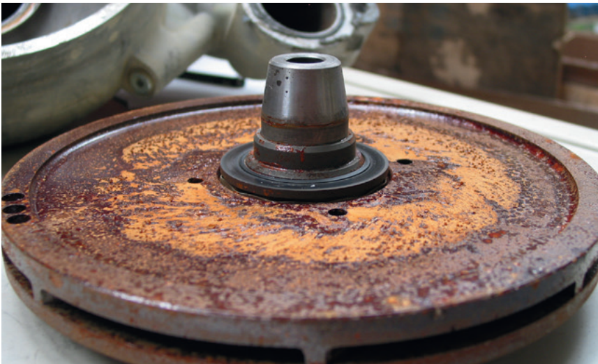
Korozyon oluşmuş kanatlı çark
